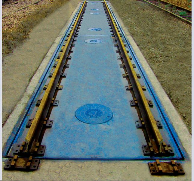
يُستخدم نظام الوزن هذا عادةً لاختبار الحافلات المستخدمة حديثاً أو الجديدة أو القاطرات لقياس وزن الحمولة على كل عجلة. وهذا بهدف التأكد من أن إجمالي وزن الحافلة أو القاطرة موزع بالتساوي على كل المحاور. أحدث تقنية من الشركة المصممة الوحيدة لأنظمة معايرة تساوي وضغط الحمولة في آسيا.
